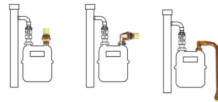
**Facilite la connexion du PLT FLEXIKIT en sortie de compteurs dans les immeubles collectifs.**
